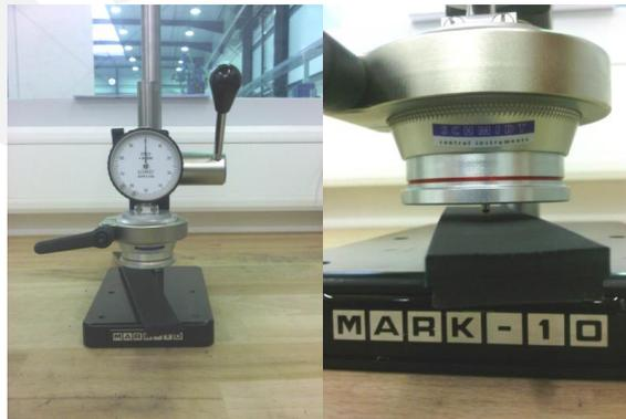
2. Zur Messung wird die Apparatur durch Druck auf den seitlichen Hebel auf die Probe abgesenkt, bis **die rote Linie gerade verdeckt ist**. Durch die Absenkung darf keinesfalls eine manuelle Kraft auf das Prüfmuster ausgeübt werden.
