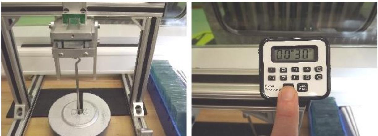
9. Es folgt der Schertest. Der Aufbau ist in den Abbildungen unten dargestellt, wobei ebenfalls das Gewicht für 30 Sekunden angehängt wird.
