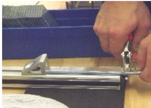
4. Mithilfe der Abstandhalter-Auftragshilfe werden die Abstandhalterstücke mit der Dampfsperre nach außen auf der ersten Glasscheibe appliziert.
