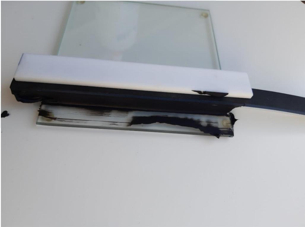
Mit der Spachtel verdrücken Sie einerseits den Dichtstoff gut zwischen Abstandhalter und Glasplatte, damit möglichst keine Luftblasen im Dichtstoff verbleiben und entfernen überstehenden Dichtstoff seitlich vom Abstandhalter. Somit ist eine immer gleichbleibende, replizierbare Prüfung der Haftung möglich.
