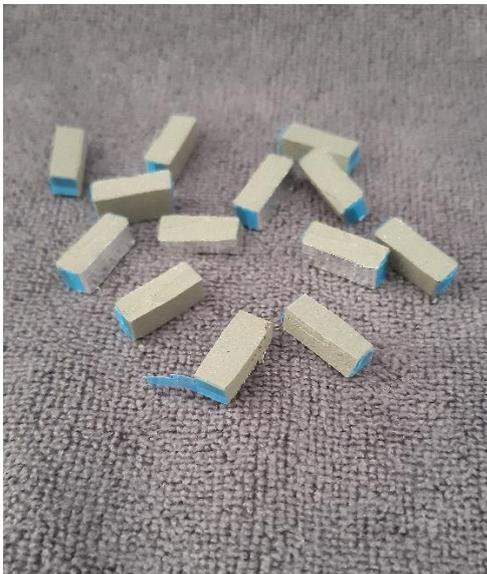
Nehmen Sie von dem zu testenden Super Spacer® ein Musterstück und schneiden dieses auf ca. 4 mm Breite zum Befüllen des Glasfläschchens. **(Bitte die Schutzfolie nicht von den seitlichen Klebeflächen entfernen)**
