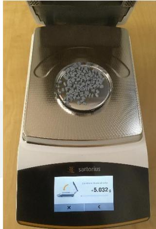
11. Nach Erreichen der eingestellten Temperatur von 190 Grad C dokumentiert die Waage nun den Gewichtsverlust der Probe.
