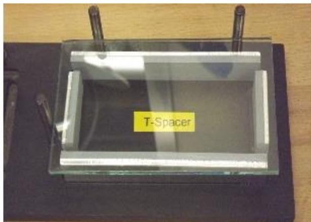
5. Die erste Glasscheibe wird nun an den Orientierungsstangen angelegt und die zweite Glasscheibe wird aufgelegt.
