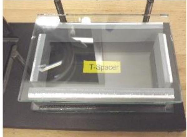
6. Das 20 lb (ca. 9,07 kg) Gewicht wird auf die Musterscheibe für 30 Sekunden aufgelegt. Dabei ist darauf zu achten, dass der Abstandhalter nicht schief appliziert wurde und der Acrylkleber eine gute Benetzung auf der Glasoberfläche zeigt (Kontaktstelle wird dunkler, wenn gut benetzt). Falls der Abstandhalter nicht senkrecht appliziert ist, ist zu prüfen, ob dies durch eine zu starke Neigung (Antiparallelität) der Abstandhalterschultern hervorgerufen wurde.
