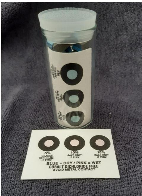
Wenn sich der 10 % - Indikator innerhalb einer Stunde wie im Bild gezeigt blau verfärbt, kann der Abstandhalter für gut befunden werden.
