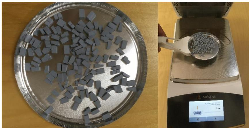
10. Senken Sie den Deckel der Waage, wodurch die Messung gestartet wird.
